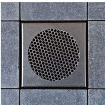
VENTICAP 110 PASSE-PARTOUT 51 55 € Inclusief pas-partout kader van 14,5x14,5 cm (wordt over het verluchttingsrooster geplaatst). Vrije lichtdoorsnede = 50 cm 2 . Diameter 110mm. 5425027379109 - VC110PP
